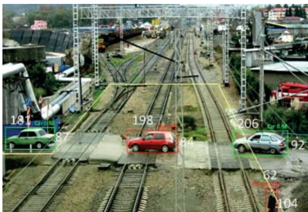
■ Рис. 1. Размер объектов наблюдения на кадре с разрешением 1280 \times 720 пикселей
