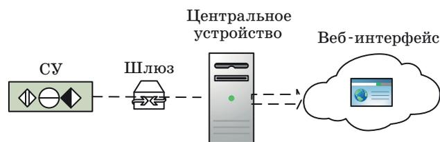
■ Рис. 2. Схема макета системы детектирования
