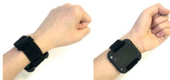
■ **Рис. 7.** Прототип носимого сенсорного устройства, размещенного на запястье
