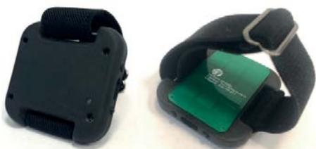
■ **Рис. 2.** Прототип носимого сенсорного устройства
